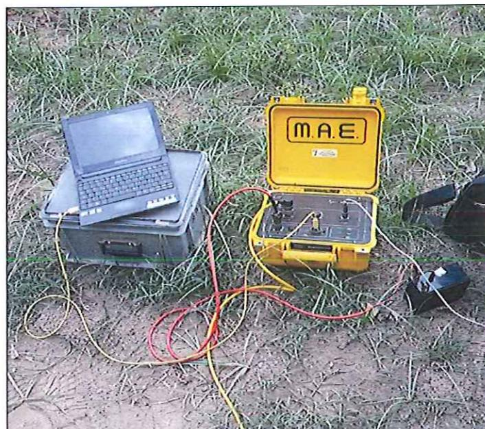
Attrezzatura per sismica MASW
