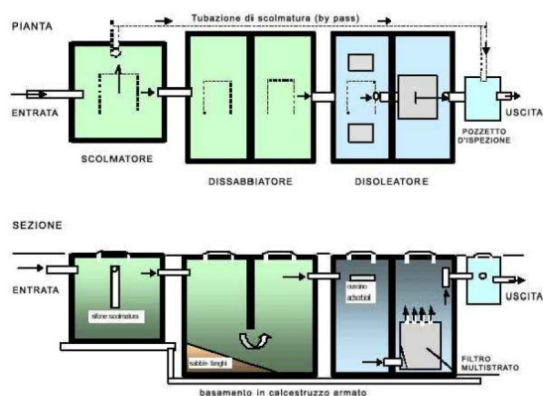
schema impianto di pretrattamento
