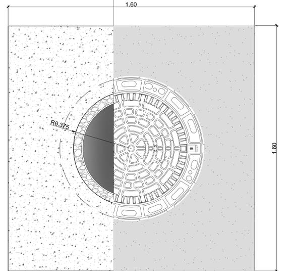
N.B.: (1\*) IL CHIUSINO ADOTTATO PER I POZZETTI RICADENTI ALL'INTERNO DELLE CARREGGIATE DOVRA' ESSERE CLASSE D400.
