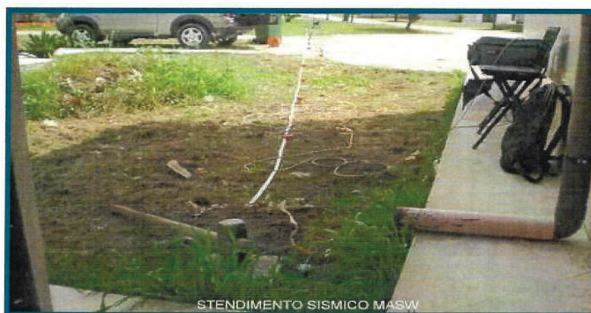
Figura 2: ESEMPIO DI STENDIMENTO SISMICO
